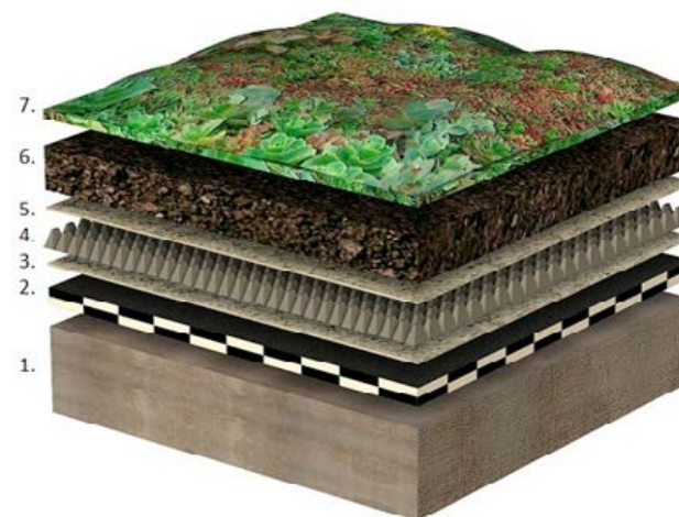
Figuur 9: Basisopbouw daktuin met wortelwerende dakbedekking.
