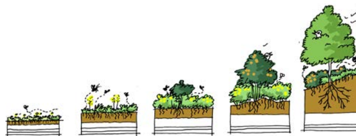
Figuur 10: Een meer gevarieerde en zwaardere beplanting vraagt een dikkere substraatopbouw.
